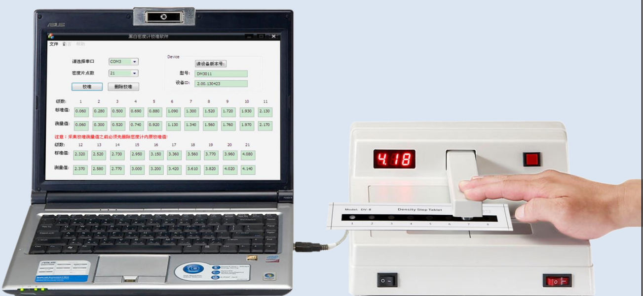
通过自带的校准软件及标准密度片，使用者可以自行校准本仪器。
